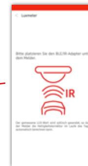
Für die B.E.G. KNX-Melder ab Generation 6 kann der BLE-IR-Adapter auch als Luxmeter verwendet werden.
